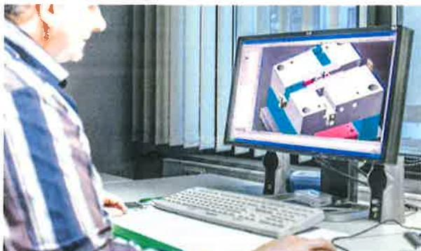
Seit über 50 Jahren werden bei der Firma Zismann Druckguss die verwendeten Formen im eigenen modernen Formenbau konzipiert, weiter entwickelt und angefertigt. Hierzu stehen unseren hochqualifizierten Formentechnikern CNC gesteuerte HSC Fräsmaschinen, Erodieranlagen und Tuschierpressen zur Verfügung. CAD Daten werden direkt vom Konstrukteur zentral und in Echtzeit in die benötigten Maschinen eingespeist.
